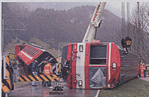
Rys. 7. Szwajcaria - wykolejony silnymi podmuchami pociąg.
