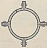
Abb. 92. Querschnitt eines aus Profileisen zusammengenieteten eisernen Pfahles.
