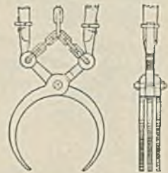
Abb. 215. Steinzange für Beseitigung von Hindernissen unter Wasser.
