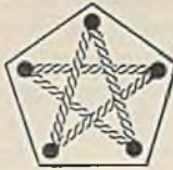
Abb. 60 a u. 60 b. Fünfeckiger Querschnitt der neuen Bauweise mit abwechselnder Querbewehrung in radialer und diagonalen Richtung.
