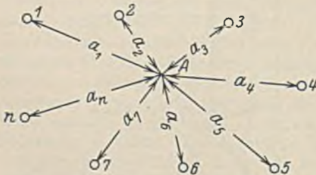
Abb. 212. Theoretischer Grundriß einer Brunnenanordnung.
