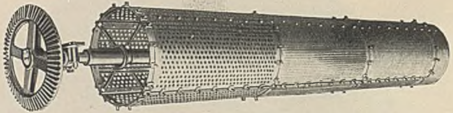
Abb. 350. Sortiermaschine der Maschinenfabrik Dr. Bernhardt (Trommel aus starkem gelochten Stahlblechen. Befestigung an auf den Wellen aufgesetzten Armsternen).
