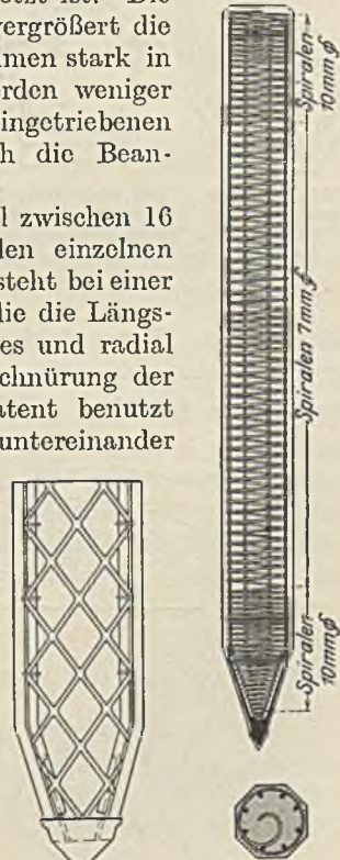
Abb. 57. Eisenbetonpfahl mit Streckmetallumschnürung Bauart Weirich und Reinken.
