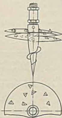
Abb. 238. Erdbohrer (D. R. P.) zur Auflockerung des Baugrundes bei Verdichtung mit Zement.
