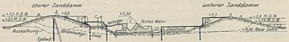
Abb. 192. Abschluß der Baugrube für das Hemelinger Wehr. Erdfangedamm mit einer Kernspundwand im Oberwasserabschluß. Grundwasserabsenkung.
