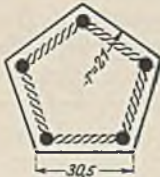
Abb. 60 a u. 60 b. Fünfeckiger Querschnitt der neuen Bauweise mit abwechselnder Querbewehrung in radialer und diagonalen Richtung.
