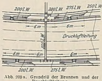
Abb. 209 a. Grundriß der Brunnen und der Druckluftleitung.
