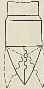
Abb. 77. Alligator-Pfahlspitze des Simplexpfehles.
