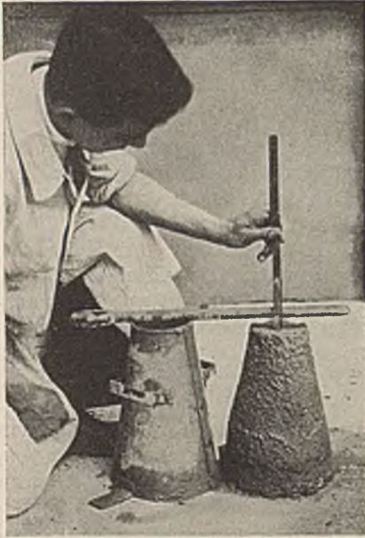
Abb. 13. Die Setzprobe. Messen des Plumpsmaßes. (Nach Grün.)
