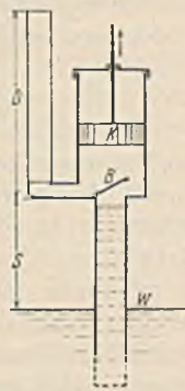
Abb. 72. Wirkungsweise der Saug- und Druckpumpe.
