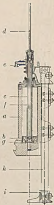
Abb. 162. Wirkungsweise des Menckschen Dampfbären.
