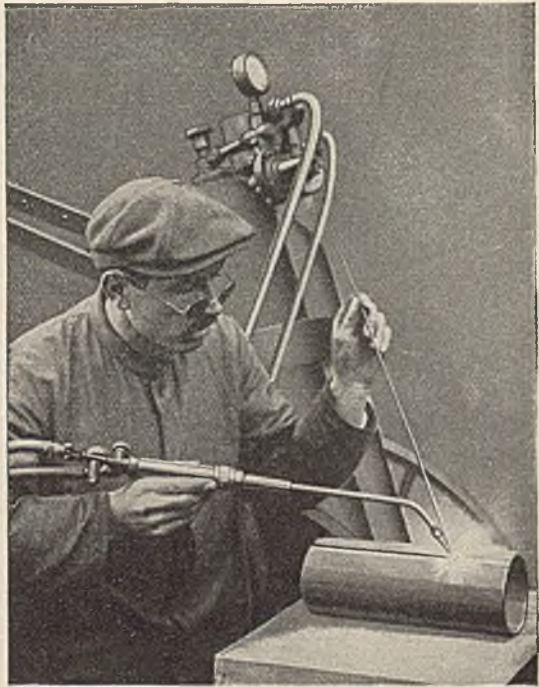
Abb. 115. Gasschmelzschweißung und ihre Zubehörteile. (Griesheim-Elektron.)
