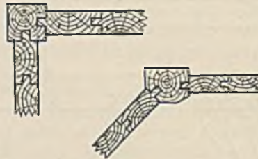
Abb. 96. Bundpfähle hölzerner Spundbohlen.
