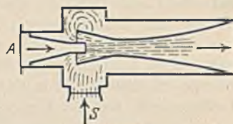
Abb. 90. Wirkungsweise der Strahlpumpe.
