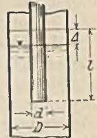
Abb. 9. Grundwassermessung im Bohrrohr.
