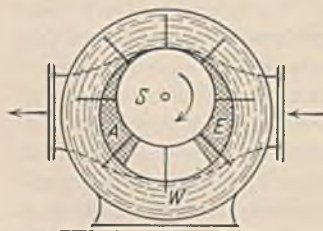
Abb. 83. Wirkungsweise der Wasserring-(Elmo-)Pumpe.
