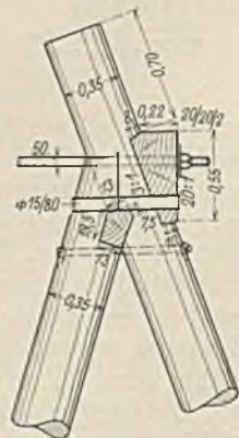
Abb. 53. Hölzerner Pfahlbock für eine Verankerung in Bremen.
