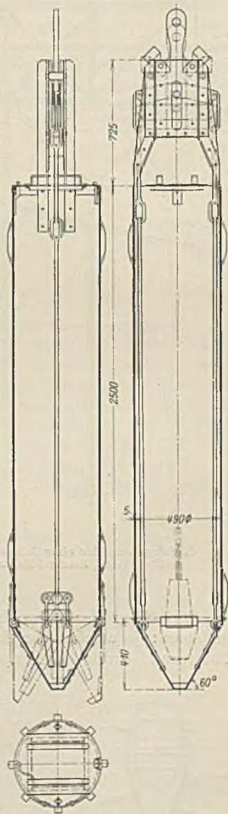
Abb. 86. Betonkübel, 500 l Inhalt zum Ausbetonieren der Pfähle der Lidingsbrücke.
