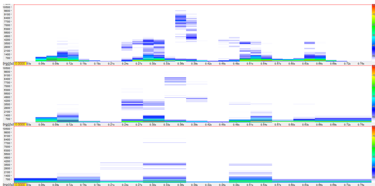
rys. 4.1:2 Spektrogramy uzyskane dyskretną analizą STFT dla szerokości okna (od góry): 23.2ms, 46.4ms, 92.9ms. Zrzut ekranu z programu WaveBlaster.
