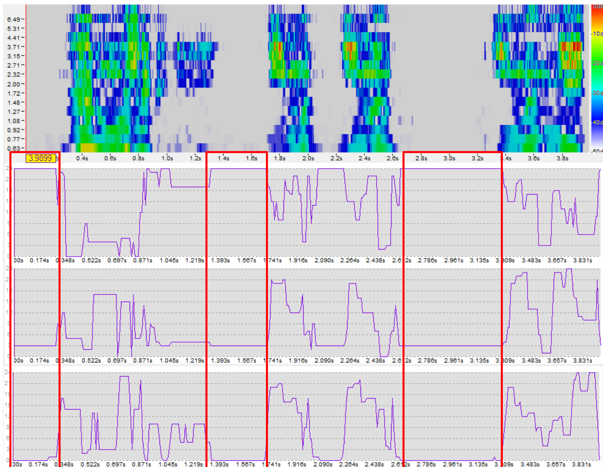
rys. 5.1:8 Różne sekwencje indeksów wygrywających neuronów sieci Kohonena 5x5 dla wypowiedzi „garnuszek im im im mniej”. Najniższy wykres jest uzyskany zmodyfikowanym algorytmem trenowania – ciska jest zawsze reprezentowana przez neuron nr 0. Zrzut ekranu z programu WaveBlaster.
