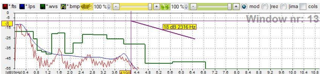
rys. 10.6:1 Panel widm Fouriera, liniowej predykcji i analizy falkowej programu WaveBlaster
