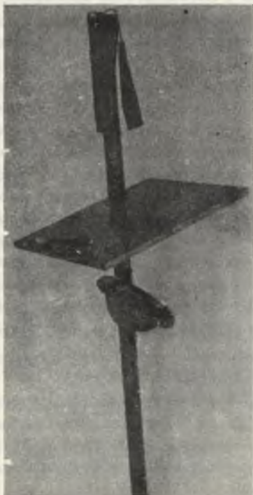
Rys. 1. Kotew rozprężna ET-3
