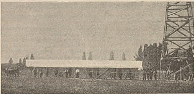
Fig. 45. Pomiar podstawy przyrządem, utrzymywanym w temperaturze topnienia lodu.
