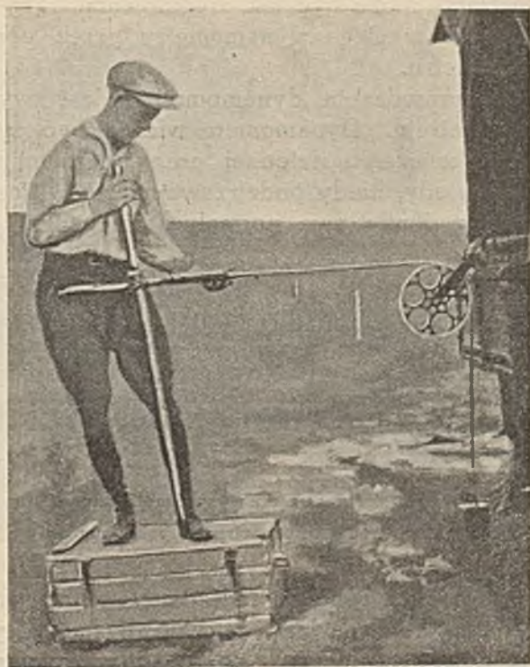
Fig. 50. Sprawdzanie dynamometru zapomocą przepi-sowego ciężaru na bloku o małym tarcu.
