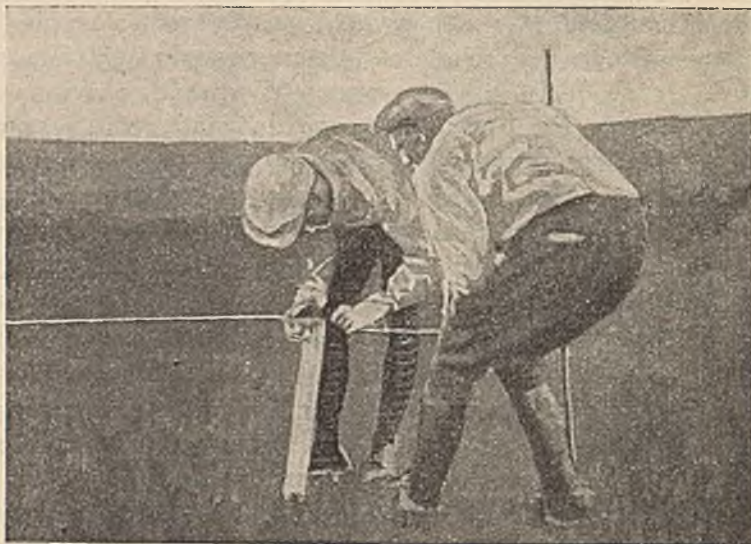
Fig. 55. Pomiar podstawy. Nastawianie tylnej kreski końcowej.
