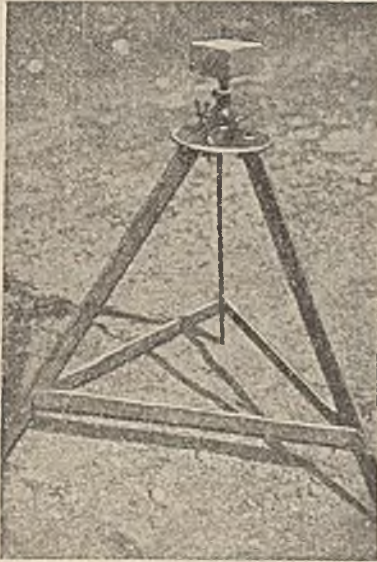
Fig. 52. Przenośny trójnóg żelazny do pomiaru podstaw.
