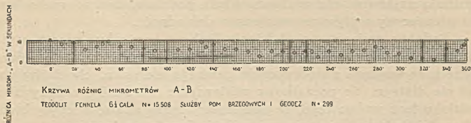
Fig. 22. Różnice odczytów mikrometrów A i B przy nastawieniach rozmieszczonych równomiernie na limbusie.
