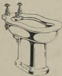
Abb. 465. Bidet, freistehend, mit breitem Sitzrand für Warmwasserzirkulation und Sitzverlängerung, mit \frac{1}{2} "igen Füllventilen für Kalt und Warm, Ablaufventil mit Stöpsel, Kette und Überlauffieb. Armaturen: Messing, vernickelt. (Bamberger, Leroy & Co., Frankfurt a. M.)
