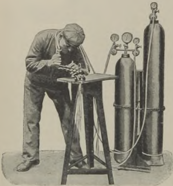
Abb. 148. Komplette Schweiß- bzw. Schneid-ausrüstung, transportabel. (F. G. Farbenindustrie A.-G., Werk Autogen, Griesheim a. M.)
