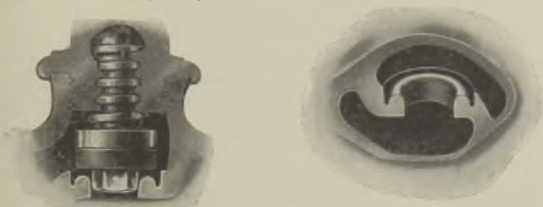
Abb. 345. Der kräftige Ventilsitz des guten Zapfhahnen ist stark hinterdreht, hat breite Dichtungsfläche und genügend weiten Durchgang. Folgen: Gut wirksame Abdichtung, mehrmalige Möglichkeit, den Ventilsitz nachzufräsen; deshalb: lange Haltbarkeit des Hahnen. (C. Kestler, Jahr i. B.)
