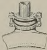
Abb. 445. Klosettspülrohr-Verbindung mittels Gummiverbinder „Saxonia“. („Erfo“, G. m. b. H., Dresden.)
