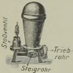
Abb. 219. Hydraulischer Widder (selbsttätige Wasserpumpe).
