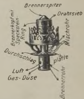
Abb. 161. Auerbrenner (Normalbrenner) für stehendes Gasglühlicht.
