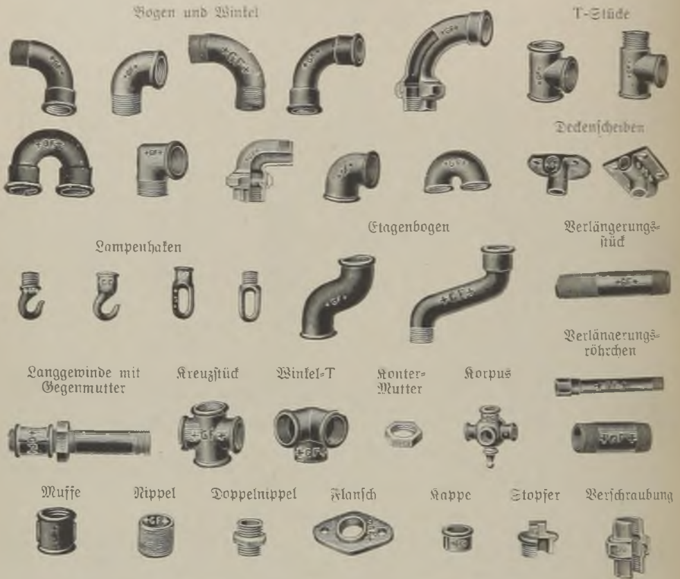
Abb. 88. Formstücke aus Temperguß. Marke: G. F. (echte Schweizer Fittings) der Firma G. Fischer'sche Stahlwerke A.-G., Singen i. B.
