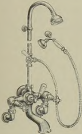
Abb. 484. Wannenfüll- und Brausebatte-rie mit Bogenverschraubungen und verstellbaren Wandrossetten, Brauserohr mit fester Brause, eingebautem Dreiweghahn, mit 80 cm langem, vernickeltem Metallschlauch, Handbrause und Aufhängehaken, Messing, vernickelt, \frac{1}{2} " \frac{3}{4} ".
