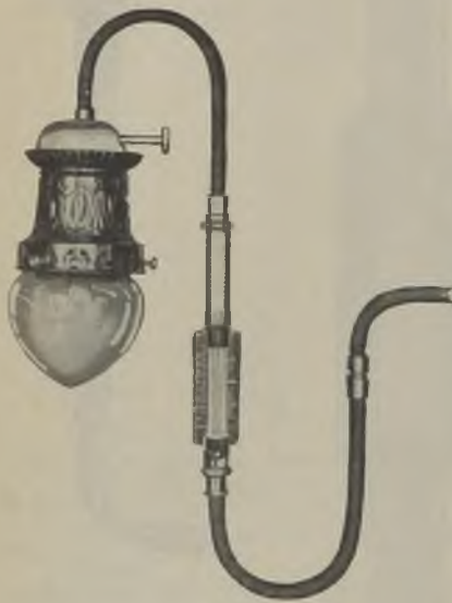
Abb. 64. Der Taschen-Gasmesser in Verbindung mit einem Hängelicht-Brenner. (Pittsch, A.-G., Frankfurt a. M.)
