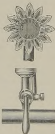
Abb. 174. Hahnstellung bei großer Flamme etwa 400 l/Std. Gasverbrauch.
