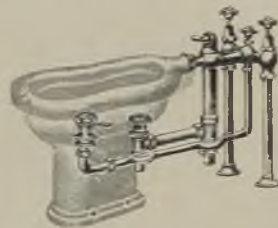
Abb. 466. Bidetanlage, freistehend, mit Hartsteingut-Beden, innen und außen weiß glasiert — für Randspülung und Unterbusche sowie vereinigter Ab- und Überlauf-Vorrichtung mit Umlegehebel. (Reichert & Enfinger, Stuttgart.)
