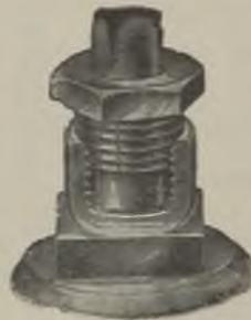
Abb. 343. Die Stopf- büchse des gutkon- struierten Zapfhahnes hat großen Raum für die Packung und kräftige Sechskantschraube. Wirkung: Schraube kann mehrmals nachgezogen wer- den. (C. Reßler, Lahr i. B.)
