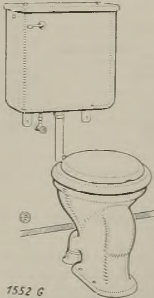
Abb. 418. Einzelklojett, frostfrei, System „Erfö“-Dresden, mit selbsttätiger Spülung durch Hochgehen des Sitzes. Siphon des Beckens und Speiseventil liegen außer Frostbereich. (Vgl. Abb. 422!)
