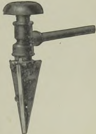
Abb. 100. Rohraufbohrer mit Rätzsche (Brustleier). (Sahn & Kolb, Stuttgart.)
