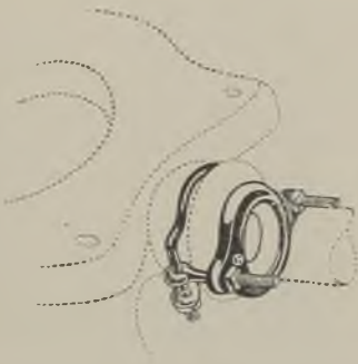
Abb. 443. Einlaufverbindung von Spülrohr und Klosettchale mittels Gummiring, Bügel und Verschraubung aus Messing, vernickelt (oder auch Eisen, verzinkt). (Bamberger, Veroi, & Co., Frankfurt a. M.)
