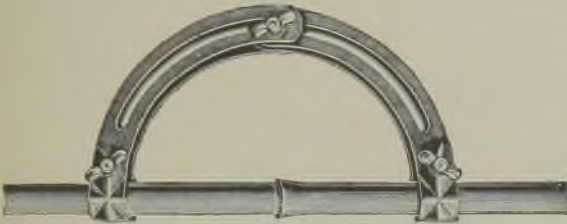
Abb. 272. Lötflammer für Bleirohrstößen (mit Rohrstößen). (Albert Stahl, Stuttgart.)
