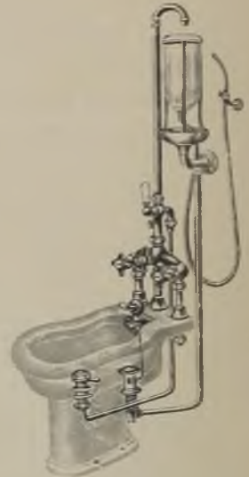
Abb. 467. Freistehende Bidetanlage mit Irrigator, bestehend aus innen und außen weißglasiertem Hartsteingutkörper, Umstellhahn für Randspülung und fester Unterbusche mit Brausestrahl, Irrigatoranlage mit Irrigatorglas, Fangschale, Gummischlauch, Hartgummimutterrohr mit Hahn und Schlauchhalter sowie vernickelter Ab- und Überlaufgarnitur mit Umlegehebel. (Reichert & Enfinger, Stuttgart.)
