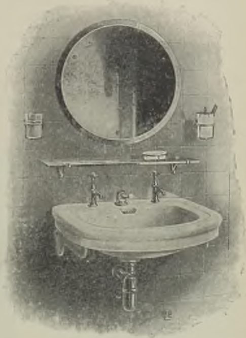
Abb. 363. Waschtisch aus Diamant-Feuer-ton, mit offenem Überlauf. Montage frei von der Wand auf gußeisernen porzellan-emaillierten Konsolen. (Bamberger, Leroi & Co., Frankfurt a. M.)
