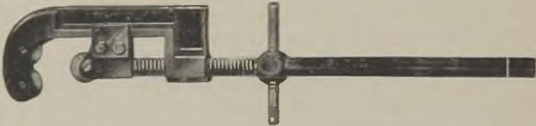
Abb. 95. Rohrabschneider mit drei Schneidrädchen. (Hahn & Kolb, Stuttgart.)
