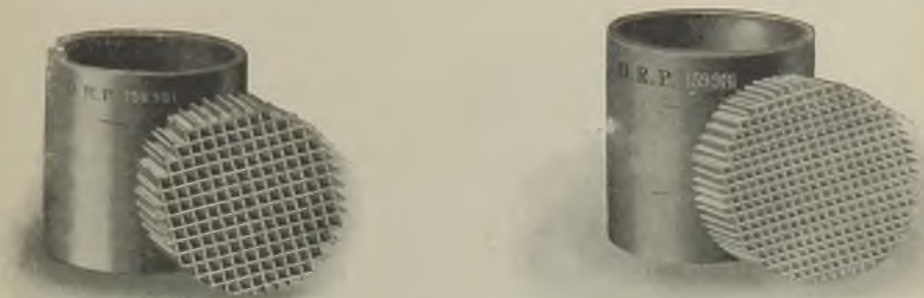
Abb. 200 a u. b. Glasglocken zum Meßer-Brenner: a. mit normalem Zellenkörper; b. mit feinem Zellenkörper. Patent der Firma P. F. Dujardin & Co., Düsseldorf.
