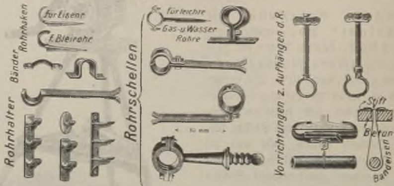
Abb. 106—108. Befestigungsmaterialien für Leitungsrohre aller Art.
