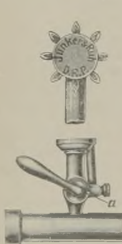
Abb. 173. Hahnstellung bei kleiner Flamme, etw. 40 Liter Gas-Stundenverbrauch. (Junker & Ruh, Karlsruhe.)
