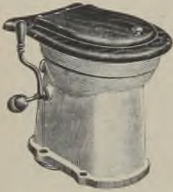
Abb. 386. Freistehendes Klappenklosett aus Hartsteingut, mit kupferverzinnter Klappe, vernickelter Achse, außenliegendem Gewicht, eisernem Hebel mit Holzgriff — Klappstüz mit Deckel aus Buchenholz. Abgang hinten oder in der Mitte. Abgangsfluge: zirka 17 oder 15 cm äußerer Durchmesser. (Reichert & Gensinger, Stuttgart.)
