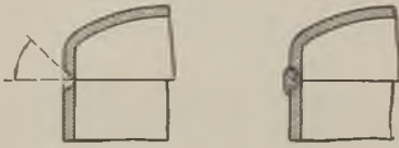
Abb. 137. Anschweißen eines Rohrbodens für Wasserbehälter ohne Überdruck, ohne Überlappung.
