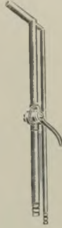
Abb. 208. Lötrohr für Gas-Luftgemisch. (Reichert & Gnjinger, Stuttgart.)
