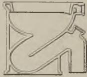
Abb. 390. Zungenklosett — aus Hartstein- gut — mit außenliegendem Abgang nach unten. (Reichert & Enfinger, Stuttgart.)
