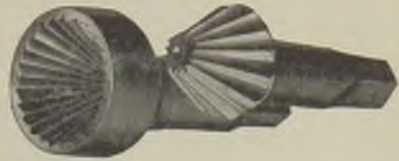
Abb. 97. Innenfräser und Außenfräser für schmiedeeiserne Röhren. (Sahn & Kolb, Stuttgart.)
