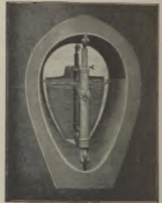
Abb. 319. Spülwagen in dem Augenblick, in dem er unter Zusammenklappen der Schildflügel ein Hindernis im Kanal überwindet.
