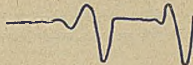
Rys. 7. Wykres drgań fundamentu młota.
