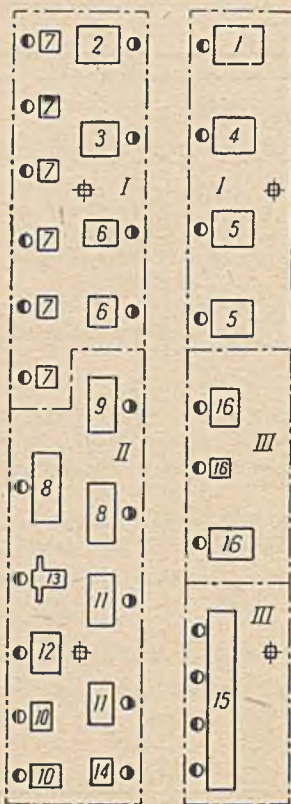
Rys. 32. Przykładowe rozmieszczenie grupowe wyposażenia wydziału tłoczenia na zimno: I — oddział tłoczeniowy, II — oddział obróbki mechanicznej, III — oddział ślusarsko-montażowy, 1 — tłocznia 100 T, 2 — tłocznia 60 T, 3 — tłocznia 40 T, 4 — tłocznia 35 T, 5 — tłocznia 25 T, 6 — tłocznia 15 T, 7 — tłocznie 3 ÷ 6 T, 8 — tokarki, 9 — maszyna tłocząca, 10 — gwinciarzki, 11 — tokarki rewolwerowe, 12 — wiertarka dwuwrzecionowa, 13 — frezarka pozioma, 14 — szlifierka ostrzarka, 15 — stół warsztatowy, 16 — urządzenia do spawania.
