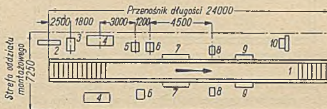
Rys. 19. Schemat rozmieszczenia wyposażenia oddziału montażowego wydziału produkcji resorów (produkcja wielkoseryjna i masowa): 1 — przenośnik montażowy członowo-płytowy, 2 — stojak, 3 — tłocznia do wtłaczania tulejek, 4 — maszyny do szlifowania końców resorów, 5 — tłocznia do przeciągania tulejek, 6 — maszyny do nitowania chomątek, 7 — dwa stanowiska do operacji ręcznych, 8 — imadła do montażu resorów, 9 — stanowiska operacji ręcznych, 10 — przechyłna prasa hydrauliczna do prób resorów na strzałkę węgla.
