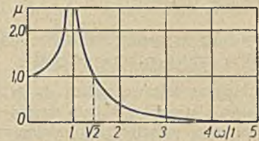
Rys. 4. Wykres zmian współczynnika dynamicznego przy izolowaniu fundamentu od drgań.
