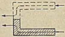
Rys. 32. Schemat rozbudowy złożonych budynków; zakreślono istniejący budynek, a linią przerywaną oznaczono jego rozbudowę.
