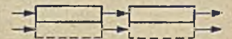
Rys. 30. Schemat rozbudowy zakładów w kierunku poprzecznym; strzałki wskazują kierunek biegu produkcyjnego, a kreski rozszerzenie produkcji.
