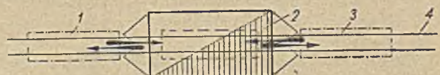
Rys. 4. Linia potokowa z wahadłowym ruchem przedmiotów w komorach przelotowych: 1 — stanowisko gruntowania i szpachlowania, 2 — suszarnia, 3 — stanowisko malowania, 4 — tor.
