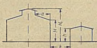
Rys. 37. Szerokość między przeciwległymi skrzydłami budynków K \geq \frac{1}{2}(H + h) lub K \geq \frac{1}{2}(H_1 + h) w tym przypadku, gdy a < 3 m.
