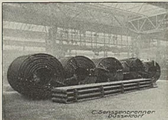
Abb. 103. Verdampferschlangen zur Abdampf-Kältemaschine, Bauart »Senssenbrenner«.
