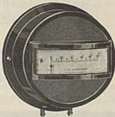
Abb. 167. Feuchtigkeits-Fernmesser für gering schwankende Raumtemperaturen nach Hartmann & Braun.
