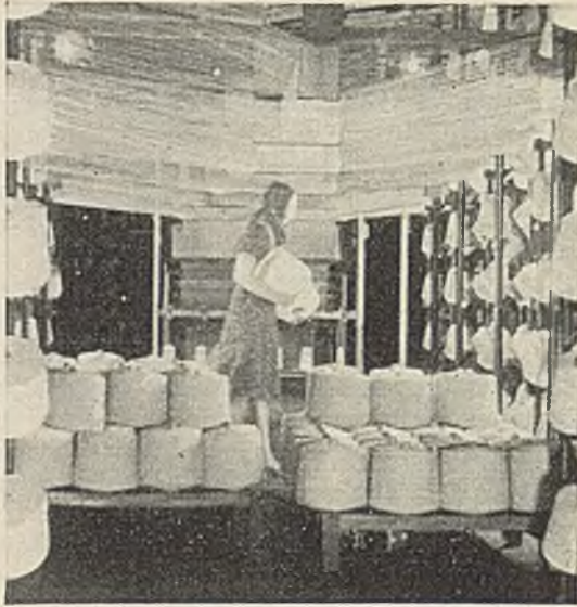
Abb. 400. Gatter für schußlosen Cord
