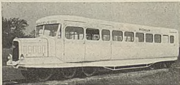
Abb. 303. Type Michelin, 48plätziger Triebwagen von Budd
