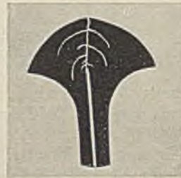
Abb. 180. »Verknoteter« Reißweg bei einer Mischung hoher Kerbzähigkeit (Kanalprozeß-Gasruß)
