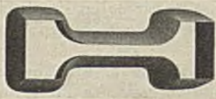
Abb. 27. Stanzmesser von Schopper
