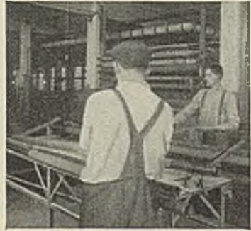
Abb. 381. Abziehen der vulkanisierten Schläuche von den Dornen
