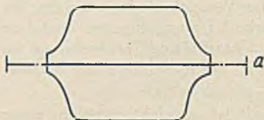
Abb. 368. Doppelreifenprofil auf Schlauchmaschine gezogen
