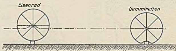
Abb. 366. Graphische Darstellung der Achsbewegung
