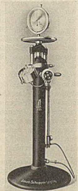
Abb. 67. Berstdruck- prüfer von Schopper
