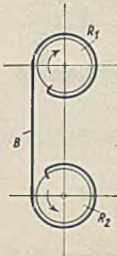
Abb. 39. Verfahren zur Prüfung von Gummibändern und -schnüren nach A. Schob
