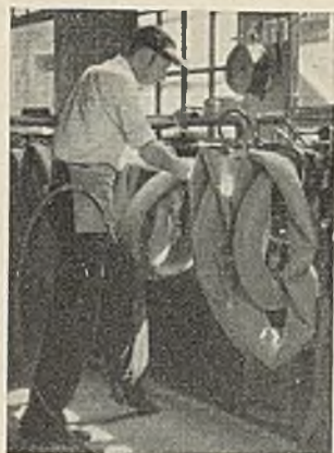
Abb. 389. Vulkanisation der Stöße am dampfgeheizten Dorn
