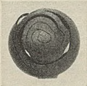
Abb. 48. In Kugelform vulkanisierte Kugel nach dem Zermürbungsversuch
