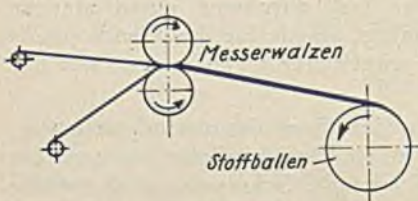
Abb. 569b. Schema der Schneidemaschine (Seitenansicht) Die Pflasterbahn wird derart geteilt, daß die nebeneinanderliegenden Pflasterstreifen die Messerwellen alternierend in zwei um 45^\circ verschiedenen Richtungen verlassen
