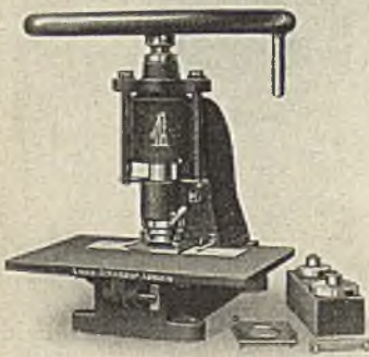
Abb. 28. Einfache Stanzpresse von Schopper
