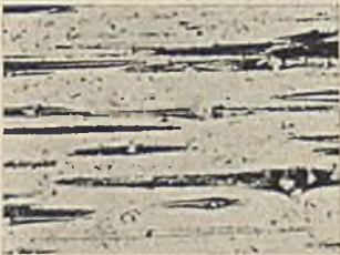
Abb. 151. Schippel-Effekt bei Schwerspat
