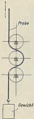
Abb. 43. Hin- und Herbiegeversuch über Rollen
