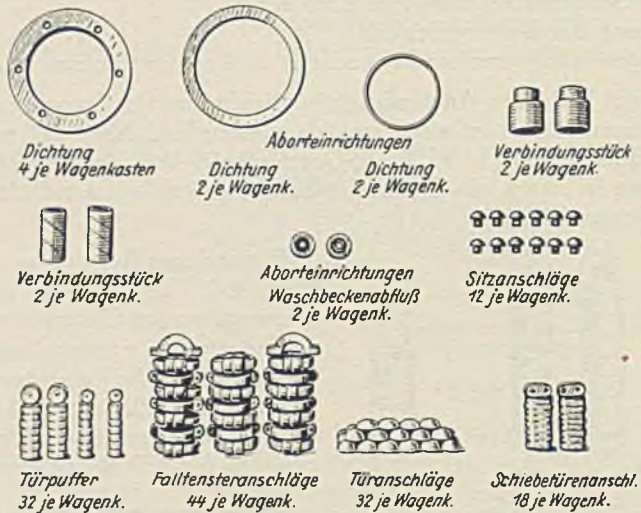
Abb. 460. Teile aus Gummi an Personenwagenkästen (8 Abteile mit Seitengang)
