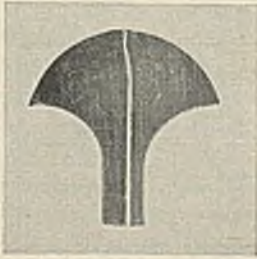
Abb. 177. Glatter Reißweg bei einer Mischung geringer Kerbzähigkeit (Kaolin)
