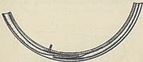
Abb. 257. „Butt-End“ Schlauch eingelegt Abb. 258. „Butt-End“ Schlauch
