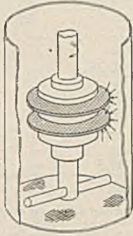
Abb. 169. Prinzip der Sproul-Evans (Goodrich) Abnutzungsprüfung
