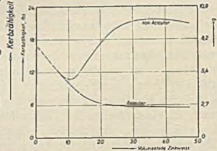
Abb. 176. Kerbzähigkeit von Mischungen mit anisotropem (Acicular) und mit nicht anisotropem (Non acicular) Zinkweiß
