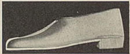
Abb. 1035. Schnitt durch einen nahtlosen KAY-Badeschuh mit Absatz
