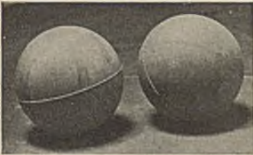
Abb. 620. Vulkanisierte Bälle mit Preßgrat
