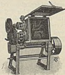
Abb. 748. Lösungskneiter (H. Schirm, Leipzig)
