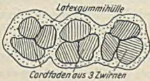
Abb. 1015. Schema eines latexgetränkten Cordstoffes
