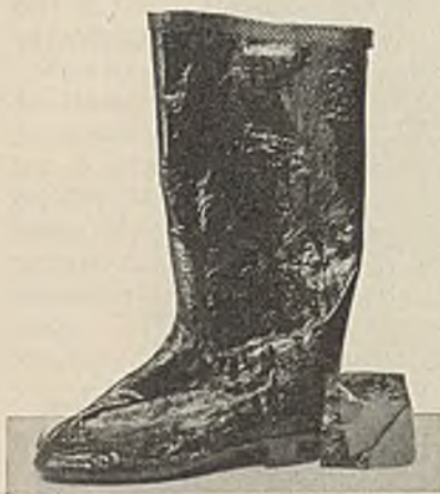
Abb. 1052. Vollständige Zerstörung eines Gummistiefels nach etwa 1½-jähriger Lagerung infolge starken Mn-Gehalts der Mischung (0,5‰ Mn). Der sich vollständig abblätternde Obergummi (s. die kleine viereckige Probe) war zu etwa 30 % azetonlöslich geworden. In diesem Extrakt waren etwa 0,3‰ Mn nachweisbar (Original-Aufnahme)
