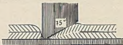
Abb. 702. Wirkung des Preß-Stanzwerkzeuges
