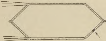
Fig. 37. Anordnung der Klebestellen der Bandumwicklung.
