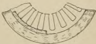
Fig. 75. Drehstrom-Ständer zur Aufnahme der Wicklung vorbereitet.
