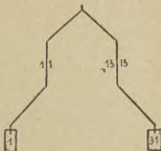
Fig. 22. Reihenschaltung einer Gleichstrom-Ankerwicklung.
