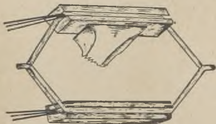
Fig. 43. Gebrauch der Ziehholzer beim Aufziehen der Formspulen im Schraubstock.
