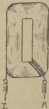
Fig. 68. Isolation eines Anfanges bei Feldspulen.
