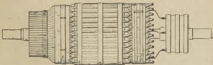
Fig. 95. Anker aus einem Drehstrom-Gleichstrom-Umformer.
