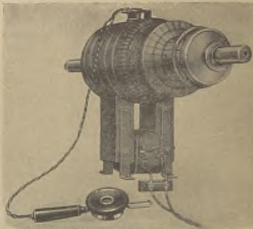
Fig. 100. Ausprüfen einer Gleichstrom-Ankerwicklung mittels Magneten und Telefon.
