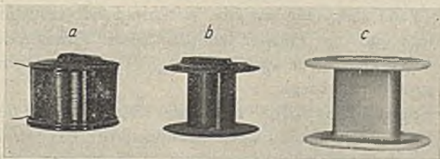
Abb. 36. Relaispule (a) sowie Spulenkörper aus Tenazit (b) und Porzellan (c).
