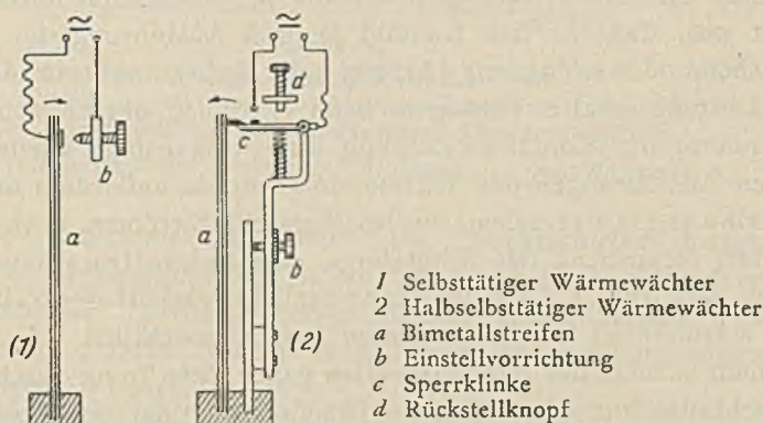
Abb. 121. Wärmewächter in schematischer Darstellung
