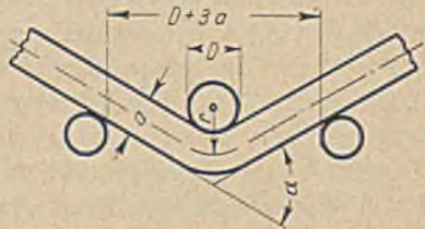
Abb. 52. Faltversuch nach DIN 1605, Bl. 4*)
