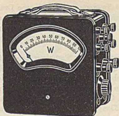
Bild 186. Äußere Ansicht eines tragbaren Drehstrom-Betriebsleistungsmessers.
