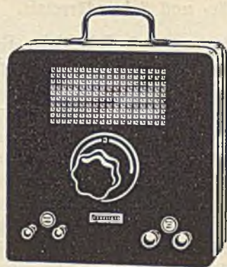
Bild 400 und 401. Tragbare Relaisprüfeinrichtung für Ströme bis 40 A. Links Ansicht, rechts Innenschaltung.
