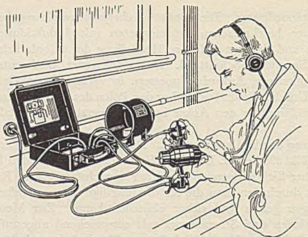
Bild 377. Ausführung einer Messung mit der tragbaren Ankerprüfeinrichtung.
