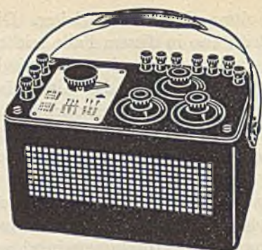
Bild 458. Äußere Ansicht des Laststrom-Transformators für Zählerprüfung am Einbauort.
