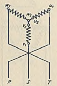
Bild 360 und 361. Parallelschaltung bei Schaltart B der Haupttransformatoren.
