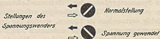
Bild 171. Schaltung des Spannungspfades der Präzisions-Leistungsmesser.
