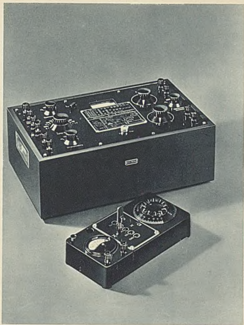
Gleichstrom-Kompensator und kleine Meßbrücke.
