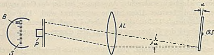
Bild 481. Strahlengang bei einem Ausschlag \alpha des Galvanometers von oben gesehen.
