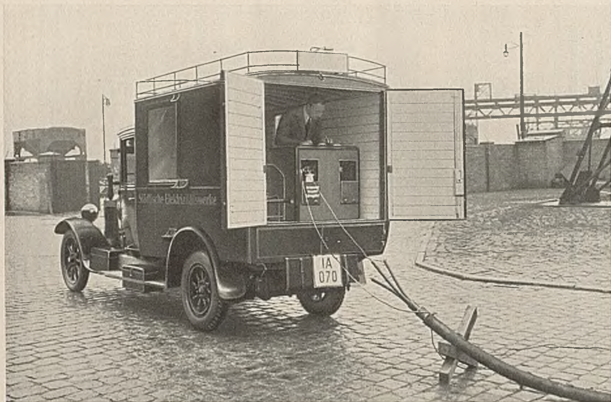
Bild 367. Fahrbare Gleichstrom-Hochspannungsanlage für 20 kV zur Prüfung von verlegten Kabelstrecken.
