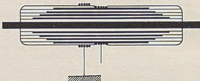
Bild 84. Schnitt durch eine Kondensatordurchführung mit Abzweig für Meßzwecke. Es wird stets die Teilspannung zwischen der äußeren geerdeten Drahtbandage und dem nächsten Stanniolbelag gemessen.
