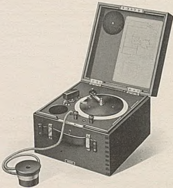
Bild 230. Äußere Ansicht der Meßdrahtbrücke für Wechselstrom.
