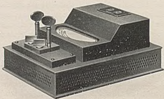
Bild 32. Äußere Ansicht eines Strommessers der Laboratoriumstyp.
