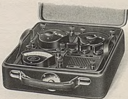
Bild 19. Gleichstrom-Meßkoffer mit Instrumenten der Z-Type, für Laboratorium und Reise. Der Koffer enthält nur ein Instrument, das je nach Bedarf mit Vor- oder Nebenwiderständen benutzt werden kann.
