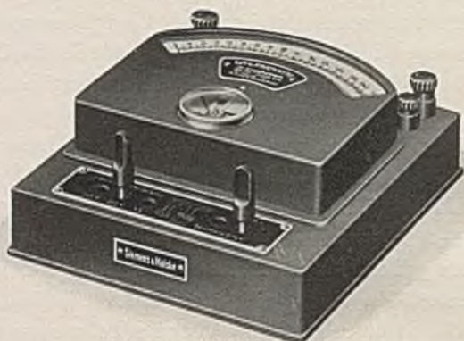
Bild 23. Äußere Ansicht des umschaltbaren Gleichstrom-Instrumentes für unmittelbar aufeinanderfolgende Strom- und Spannungsmessungen.
