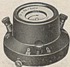
Bild 205. Äußere Ansicht des Drehfeldrichtungsanzeigers.
