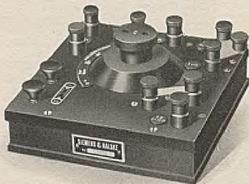
Bild 286. Schaltkästchen der tragbaren Kabelmeßschaltung für Stark- und Schwachstromkabel.
