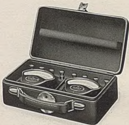
Bild 18. Drehpul-Instrumente der Z-Type. Zusammenstellung für Post und Eisenbahnbehörden. Der Koffer enthält einen Strommesser und einen Spannungsmesser mit je drei Meßbereichen.
