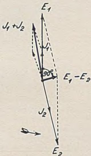
Bild 267. Vektordiagramm des neuen Erdungsmessers.
