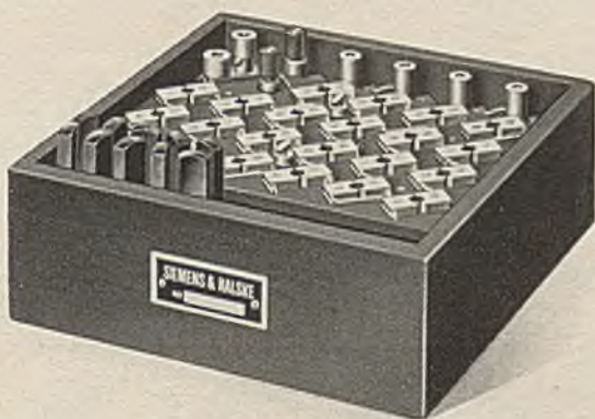
Bild 224. Ansicht der obigen Meßbrücke mit abgenommener Deckplatte.
