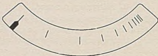
Bild 213. Skalenverlauf eines Nullspannungsmessers mit Vorschaltlampe.
