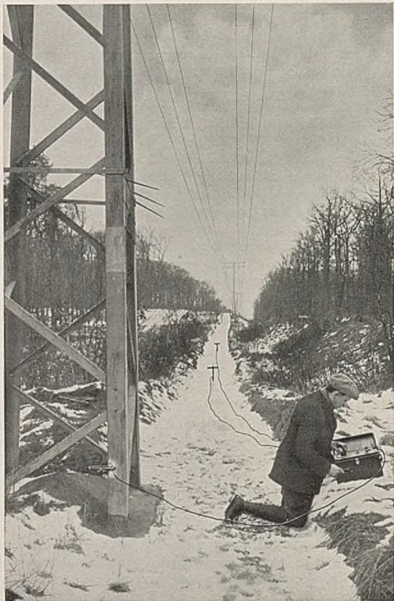
Bild 255. Betriebsmessung mit dem neuen Erdungsmesser.
