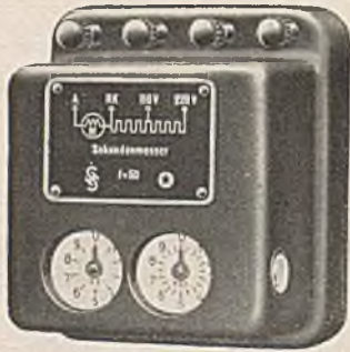
Bild 430 und 431. Elektrisch betriebener Sekundenmesser. Links äußere Ansicht, rechts Gesamtschaltung.
