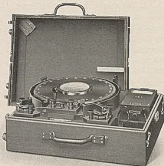
Bild 284. Fehlerortsbrücke mit Meßdraht.
