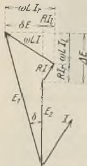
Abb. 160. Vektordiagramm einer Drehstromübertragung.
