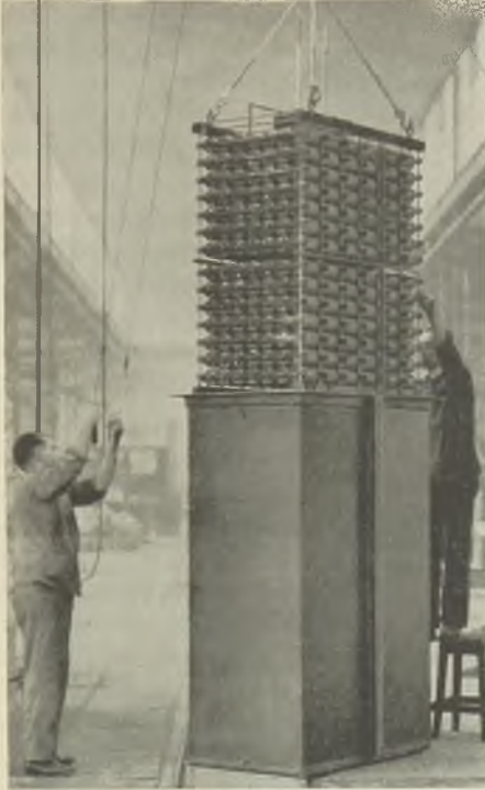
Abb. 188. Zusammenbau eines Drehstromkondensators mit horizontaler Wickelachse.
