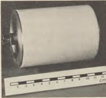
Abb. 186. Kondensatorwickel für 1 kVA bei 380 Volt.
