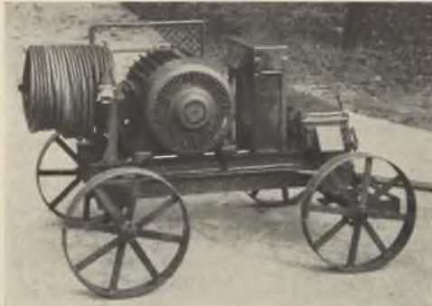
Abb. 86. Fahrmotor mit aufgebautem Kondensator für 10 kVA.
