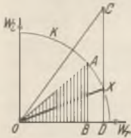
Abb. 136. Ermittlung der Kondensatorleistung zur Entlastung des Generators.
