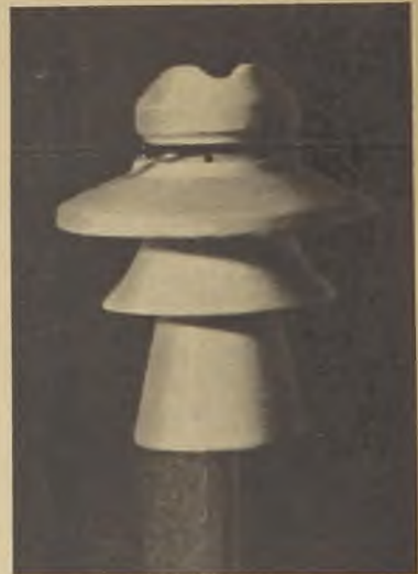
Vorentladungen zwischen Hülse und Stütze bei ganz schräger Beregnung. Fig. 55.
