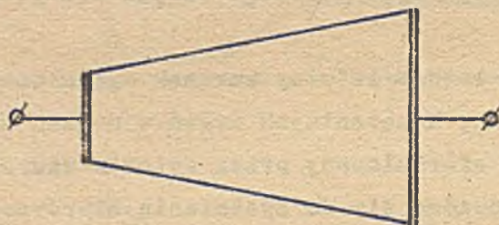
Rys. 6. Generator Gunna o kształcie umożliwiającym zmianę częstotliwości generowanej w zależności od wartości napięcia przyłożonego do elektrod
