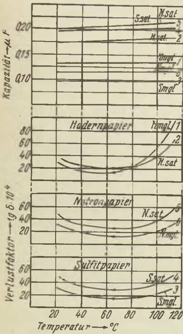
Abb. 142. Verlustfaktor und Kapazität bei verschiedenen ungetränkten Papieren in Abhängigkeit von der Temperatur (50 Hz, 250 V) (nach Nauk).
