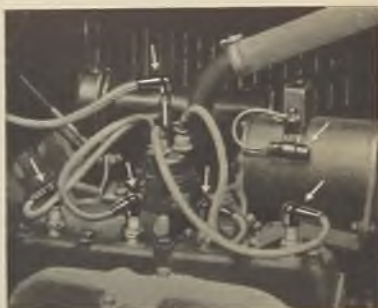
Abb. 267. Entstörung eines Vierzylinderautomobilmotors (Werkphoto Hydra).
