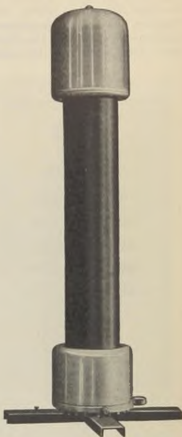
Abb. 235. Preßgaskondensator (50 pF, 500 kV, Abmessungen 1100 mm × 1100 mm × 2790 mm) (Werkphoto Hartm. u. Braun).
