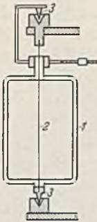
Abb. 25. Entlastete Fadenaufhängung von H. & B. 1 Drehspule, 2 Aufhängefaden, 3 Spitzenlager.
