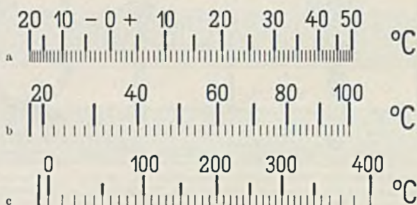
Abb. 184. Skalennuster für Kreuzspultemperaturmesser. a 180 \Omega Platinwiderstand bei 0° C, für 10 \Omega Leitung, b 90 \Omega Platinwiderstand bei 0° C, für 3 \Omega Leitung. c 100 \Omega Platinwiderstand bei 0° C, für 10 \Omega Leitung.
