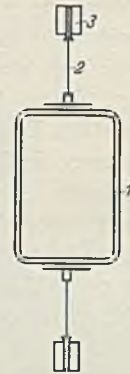
Abb. 26. Spannfadenaufhängung. 1 Drehspule, 2 Spannfaden, 3 Einspannung.
