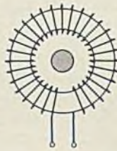
Abb. 111. Stab-Stromwandler. 1 Primärwicklung (Hochstromleiter), 2 Sekundärwicklung, 3 Wandlereisen.
