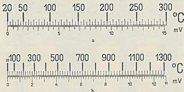
Abb. 188. Skalen thermoelektrischer Pyrometer. a Eisen-Konstantan-Element, für Leitung und Element 3 \Omega , für Drehspulgerät 527 \Omega . b Platin-Platinrhodium-Element, für Leitung und Element 3 \Omega , für Drehspulgerät 300 \Omega .
