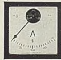
Abb. 12. Quadratisches Schalttafelinstrument von S. & H.
