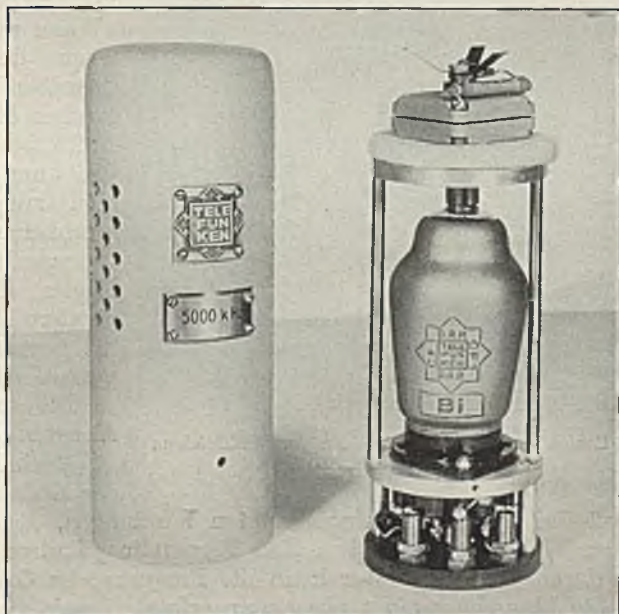
Abb. 118. Quarz-Normalsender mit sehr kleinem Temperaturkoeffizienten \Delta f/f < 10^{-6} je ^{\circ}C
