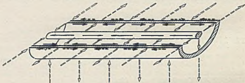
Abb. 116. Gleich- und Gegentaktwelle bei der Rohrleitung
