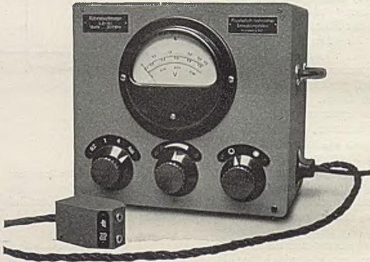
Abb. 80. Tastvoltmeter (PTE) für 0,2 14 V (10 kHz . . . 300 MHz)
