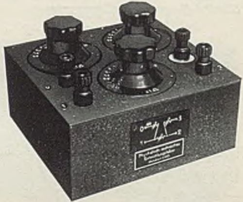
Abb. 92. Dekadenwiderstand des PTE
