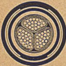
Abb. 64. Verschiedene Kabelausführungen NKBA für Spannungen bis 1000 V.
