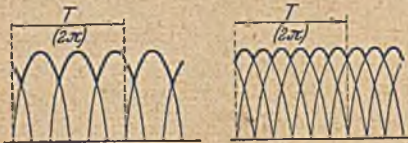
Abb. 47. Spannungsverlauf eines drei- und eines sechsphasigen Quecksilberdampfgleichrichters während einer Periode des zugeführten Drehstromes.
