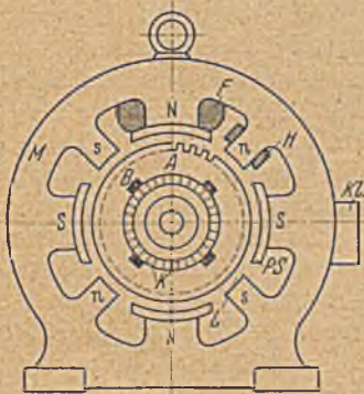
Abb. 7. Aufbau eines Gleichstrommotors. A Anker mit Ankerspulen. B Bürsten mit Bürstenhalter auf Bürstenbolzen, diese auf Bürstenstern. F Feldmagnetspule (Feldwicklung). H Hilfspolspule (Hilfsspulewicklung). K Stromwender (Kollektor, Kommutator). KL Klemmbrett. L Luftspalt. M Magnetgehäuse mit Feldmagneten. N , S Nord- bzw. Südpol. n , s Nord- bzw. Südhilfspol (Wendepole). PS Polschuh.
