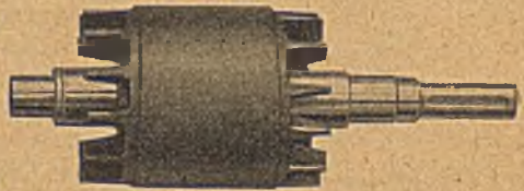
Abb. 21. Käfigläufer mit in das Blechpaket eingegossener Wicklung. Läuferstäbe, Kurzschlußringe und Ventilationsflügel ein gemeinsames Gußstück.
