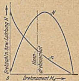
Abb. 55. Leistungs- und Drehzahlverlauf bei einem Einphasenrepulsionsmotor.
