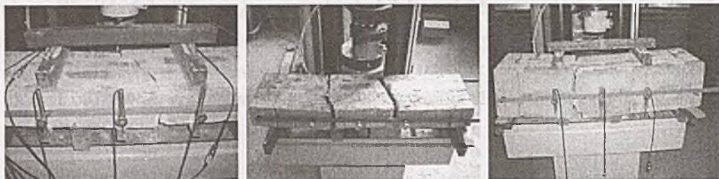
Rys. 4. Obraz zniszczenia badanych modeli Fig. 4. View of the failure modes
