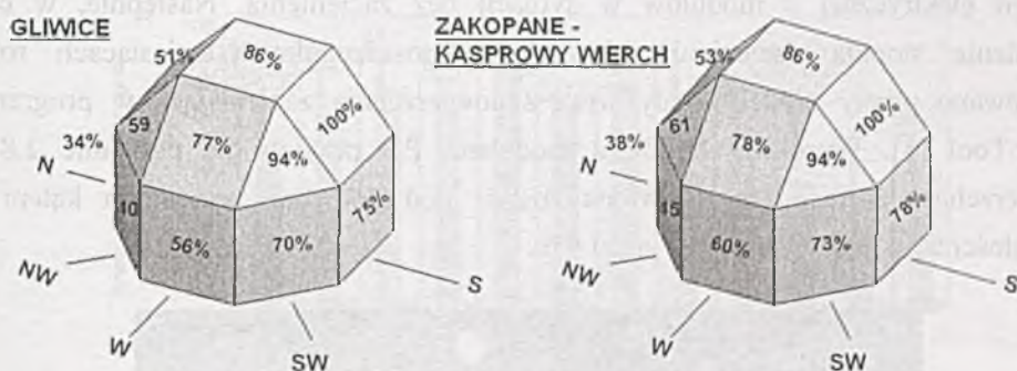
Rys. 2. Skuteczność ogniw PV na przelomie roku, w zależności od usytuowania na budynku Fig. 2. Effectiveness of PV cells during whole year depend on location on the building
