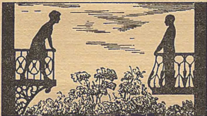
Ryc. 47 Balkony na pozór bezpieczne i niebezpieczne.
