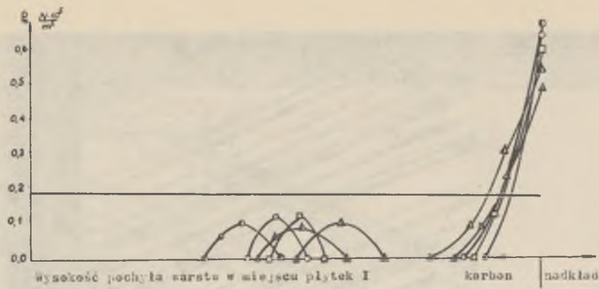
Rys. 7. Przebieg ciśnień w miejscu płytek I w czasie wpływów wybieranych pokładów 2, 3
