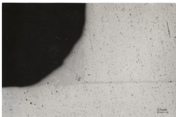
Rysunek 8. Zdjęcie struktury wypływkii lutu z połączenia lutowanego o prawidłowym wklęsłym kształcie (próbka nietrawiona)
