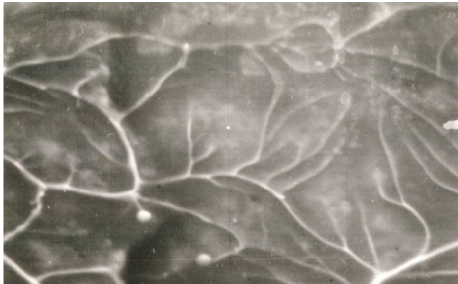
Rysunek 6. Zdjęcie struktury powierzchni przelomu amorficznego stopu Ni_{89}P_{11} po dekohezji w teście plastyczności; pow. 3000x
