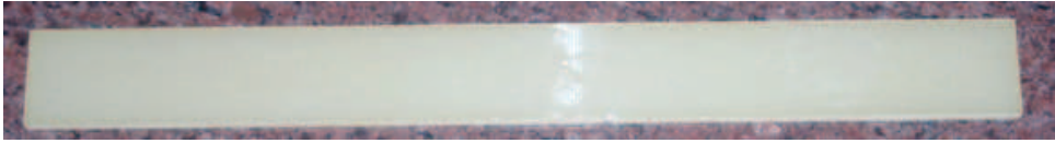
Rysunek 10.2. Kształt próbek do badań zmęczeniowych przed modyfikacją wymiarów
