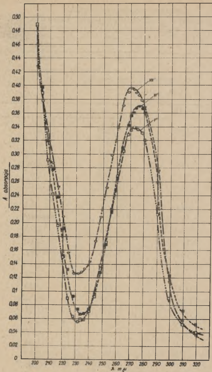
Rys. 5. Zależność absorpcji światła wodnych roztworów czterochlorogalanów tetrazoliowych V', VI' i VII' o stężeniu C = 10^{-5} M od długości fali świetlnej V' = [C_{20}H_{17}N_4O] [GaCl_4] , VI' = [C_{20}H_{16}N_4OC] [GaCl_4] , VII' = [C_{20}H_{16}N_5O_2] [GaCl_4]
