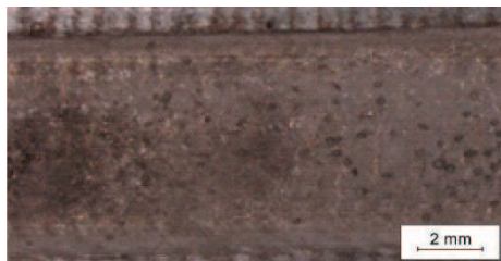
Rysunek 39. Widok lica przetopienia warstwy wierzchniej odlewniczego stopu magnezu MCMgAl9Zn1 proszku WC; moc lasera 2,0 kW, szybkość wtapiania 0,5 m/min
