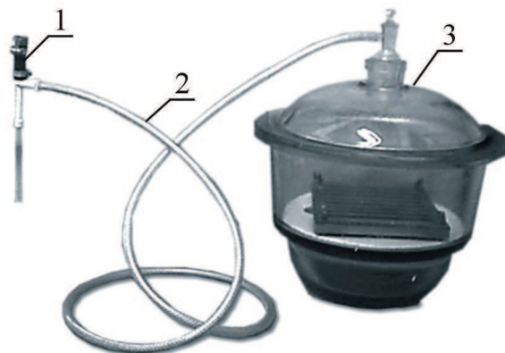
Rysunek 4.7. Stanowisko do wytwarzania próbek pod obniżonym ciśnieniem: 1 – pompa, 2 – przewód łączący, 3 – eksykator [65, 76]
