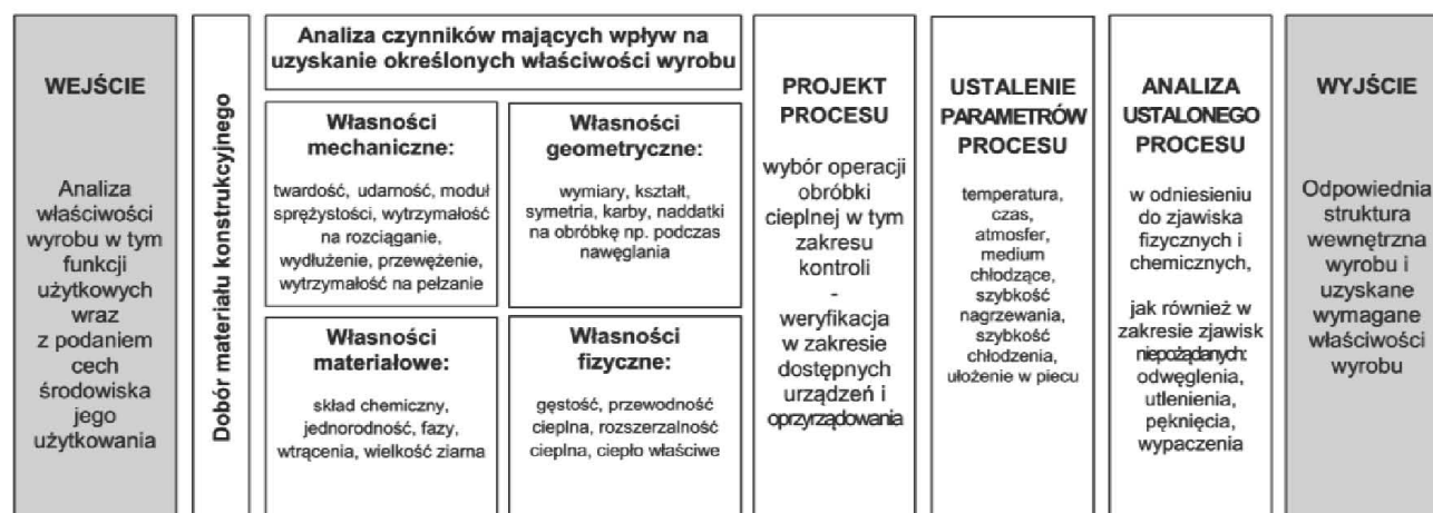
Rysunek 2. Ogólny model projektowania procesów obróbki cieplnej w ujęciu procesowym
