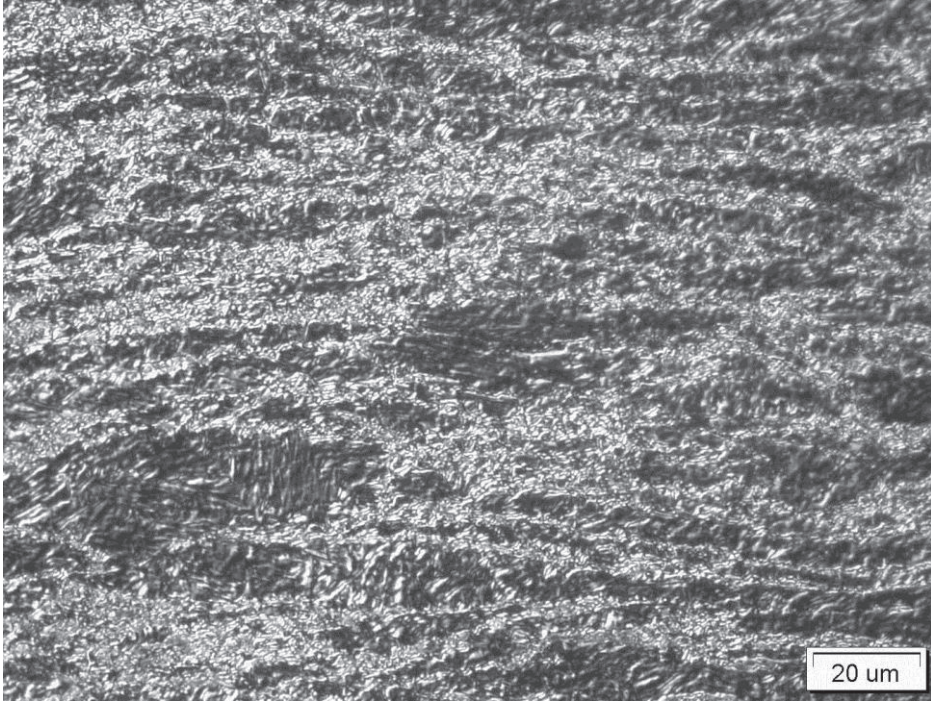
Rysunek 5.69. (ciąg dalszy): c) częściowo zrekrytalizowane dynamicznie ziarna austenitu pierwotnego w stali G1 po odkształceniu w temperaturze 900°C (powiększenie z rys.5.69b)
