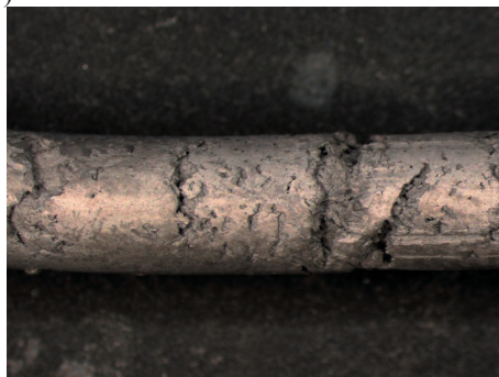
Rysunek 4.14. Obraz powierzchni bocznej profilu wytłaczanego z mieszaniny polimerowo-proszkowej WS160SA w temperaturze 140°C (a); obraz powierzchni bocznej profilu wytłaczanego z mieszaniny polimerowo-proszkowej WS160SA w temperaturze 170°C (b)
