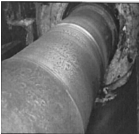
Rys. 20.2 Wygląd czopa wału po demontażu łożyska
