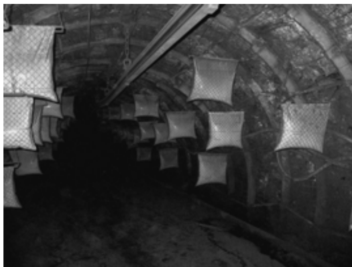
Rys. 4.4 Zapora przeciwwybuchowa wodna typu torby wodne – schodkowo-boczna
