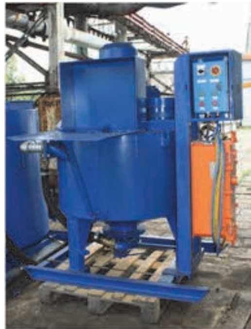
Rys. 15.6 Widok pulpitu sterowniczego mieszalnika MP oraz widok Modułu I wraz z zamocowanym pulpitem sterowniczym i wyłącznikiem kopalnianym
