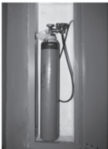
Rys. 21.13 Butla z gazem wzorcowym i U-rurka do pomiaru różnicy ciśnień przed i za tamą
