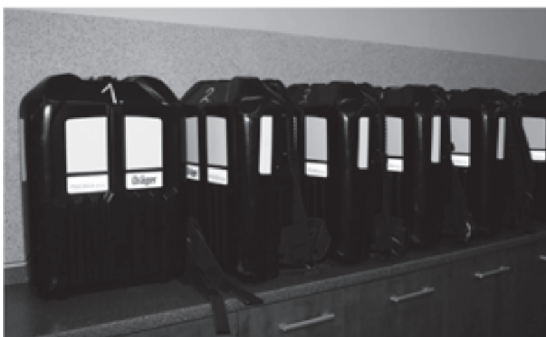
Rys. 21.6 Sala aparatowa – aparaty BG-4 Plus
