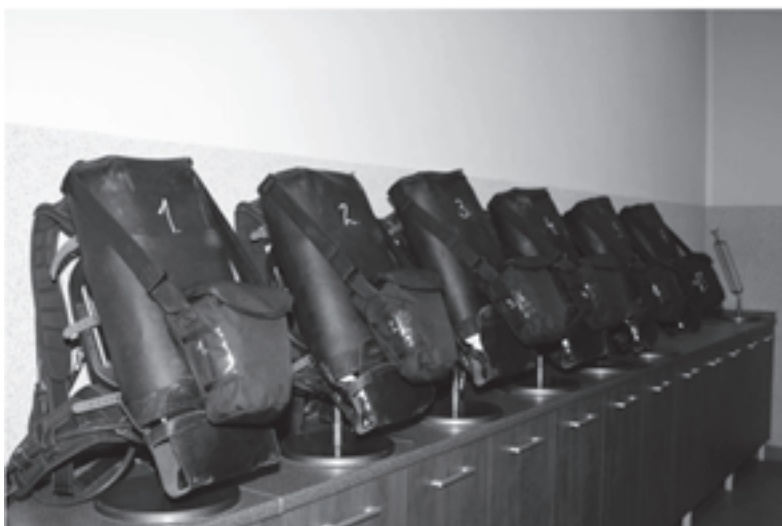
Rys. 21.5 Sala aparatowa – aparaty powietrzne PSS 7000
