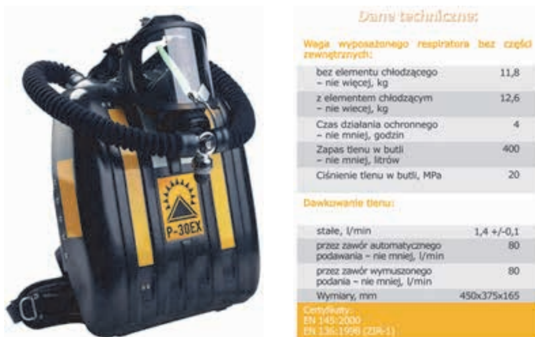
Rys. 18.2 Aparat P-30EX i jego dane techniczne [6]
