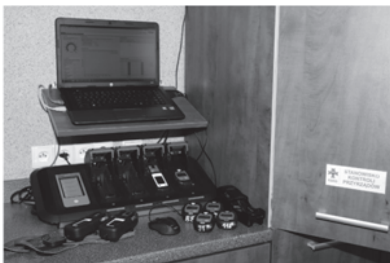
Rys. 21.7 Stacja kontroli przyrządów gazometrycznych
