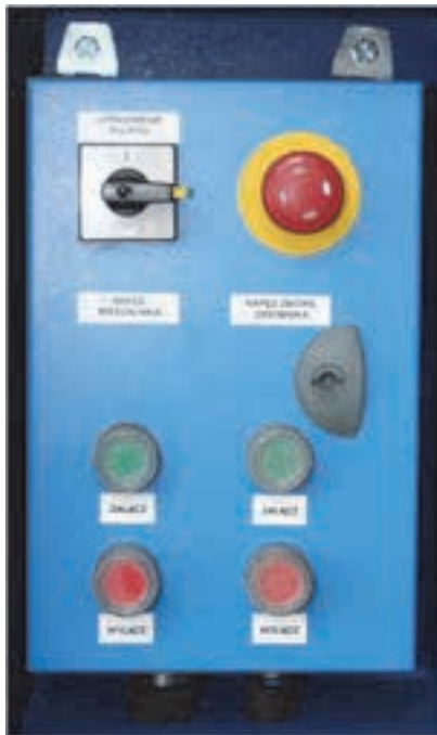
Rys. 15.6 Widok pulpitu sterowniczego mieszalnika MP oraz widok Modułu I wraz z zamocowanym pulpitem sterowniczym i wyłącznikiem kopalnianym
