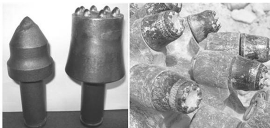
Rys. 10.9 Widok standardowego noża styczno-obrotowego oraz specjalnego noża koronowego (po lewej) oraz widok noża koronowego po 8 godzinnej pracy(po prawej) [3]
