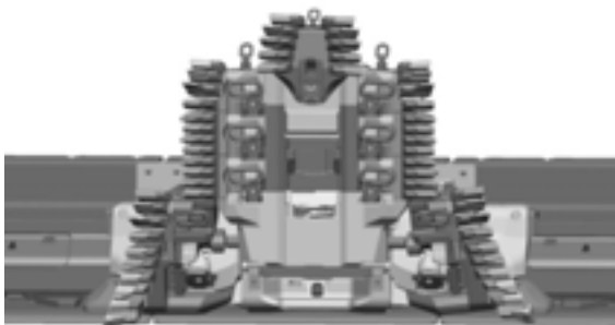
Rys. 11.5 Widok głowicy struga i stanowiska sterowania operatora zlokalizowanego w chodniku przyścianowym
