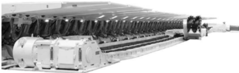
Rys 11.1. Ogólny widok zintegrowanego kompleksu FL 10/15(FL 12/18)
