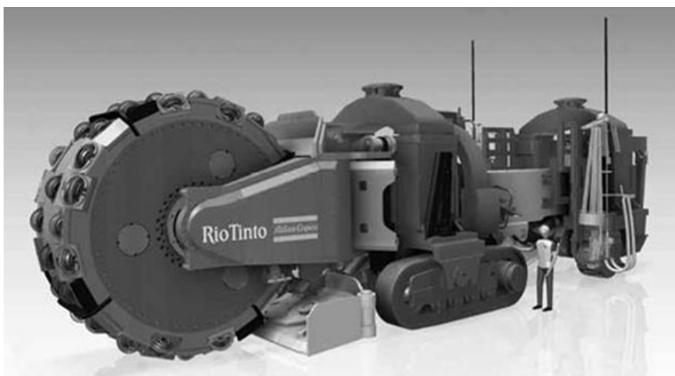
Rys. 10.19 Wizualizacja kombajnu MMM Modular Mining Machine firmy Atlas Copco dla koncernu Rio Tinto w ramach projektu „Mine of the Future” [16]
