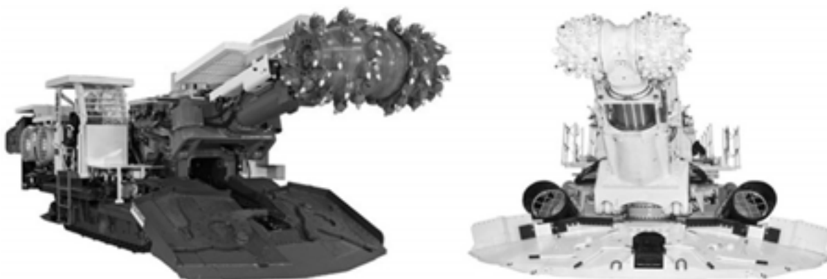
Rys. 10.3 Widok kombajnów ramionowych urabiających punktowo typu średniego MR320 (po lewej) i ciężkiego MR620 (po prawej) firmy Sandvik [11]
