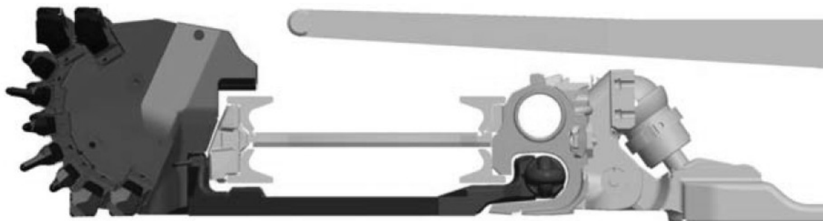
Rys 11.3 Zasada konstrukcji struga mieczowego (płytowego)
