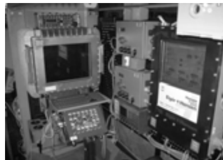
Rys. 11.5 Widok głowicy struga i stanowiska sterowania operatora zlokalizowanego w chodniku przyścianowym
