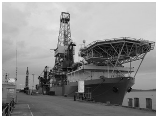
Rys. 9.4 Statek wiertniczy z systemem pozycjonowania dynamicznego Discoverer 534 w Loyang Offshore Supply Base (Singapur) w trakcie manewrów
