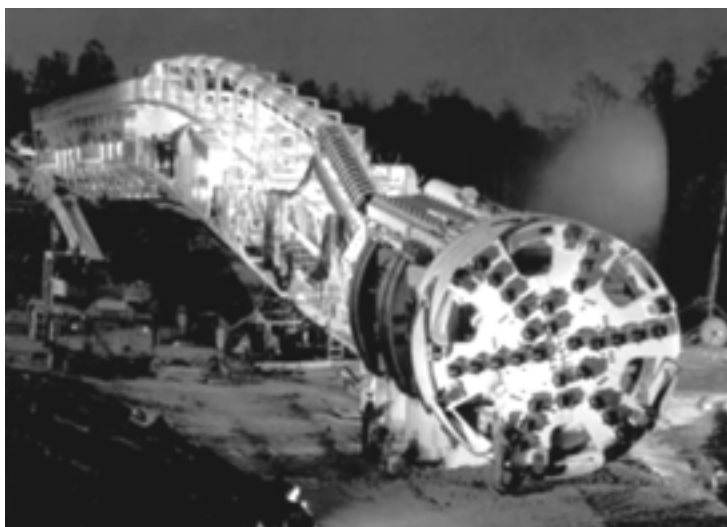
Rys. 10.12 Widok kompleksu z kombajnem pełnoprzekrojowym firmy Robbins typ MK 27 [10]
