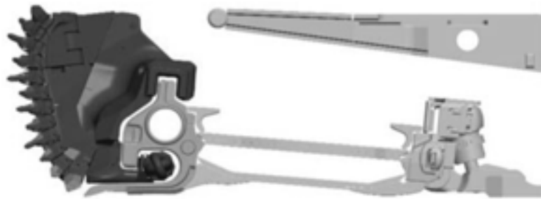
Rys 11.4. Zasada konstrukcji struga ślizgowego
