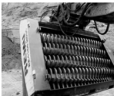
Rys. 17.8 Łyżki przesiewająco-kruszące, A- firmy REMU, B - firmy ALLU [9, 10]
