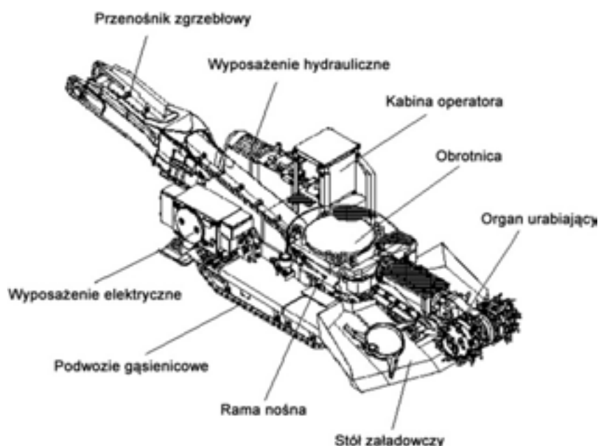
Rys. 10.2 Podstawowe podzespoły kombajnu MT-360 firmy Sandvik [11]
