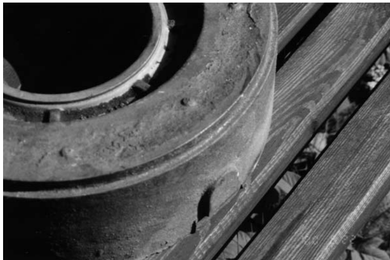
Rys.1 a), b) Przykłady występujących wad odlewniczych na górnych poziomych powierzchniach odlewów.
