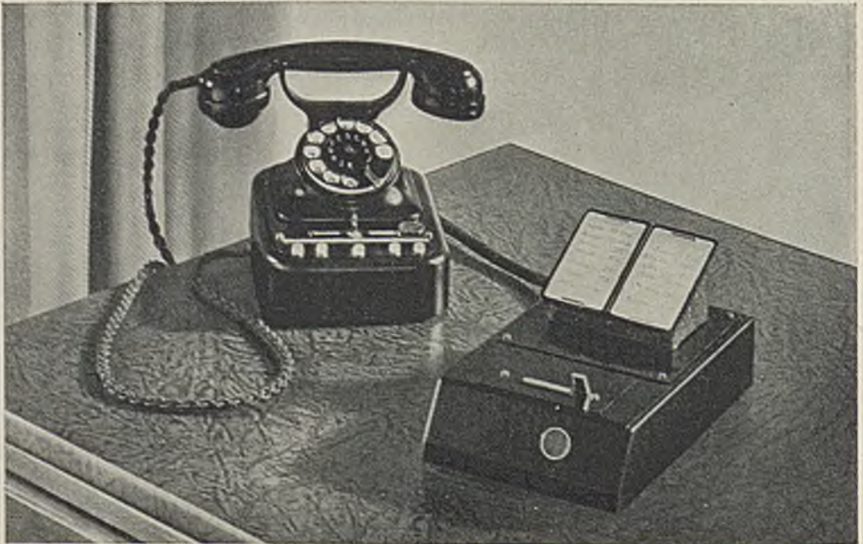
Reiha-Fernsprecher in Verbindung mit einer Vermittlungseinrichtung für Außenstellen.
