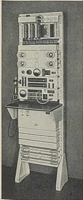
Schnurverstärkergestell mit Netzanschlußteil für 2 Verstärker und 10 Leitungen.
