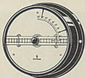
Stellungsanzeiger für eine Eisenbahn-Drehbrücke. Brücke geschlossen.
