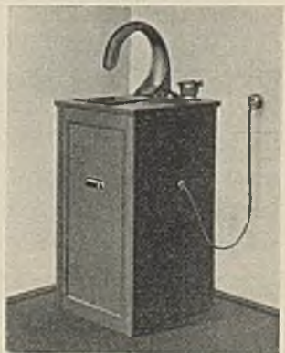
Wandtischstation einer Rohrpost-Kleinanlage, Empfang von unten und Senden nach unten. Gebläsestation.
