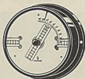
Stellungsanzeiger für eine Eisenbahn-Drehbrücke. Brücke geschlossen.
