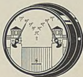
Stellungsanzeiger für eine Doppel-Klappbrücke. Brücke geschlossen.
