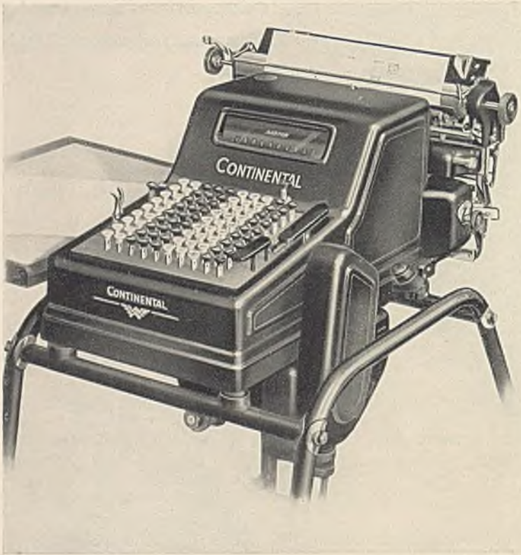
Zehnstellige Continental-Buchungsmaschine mit 47 cm breitem Schüttelwagen für mehrfachen selbsttätigen Wagensprung vor- und rückwärts, Bauart 1935
