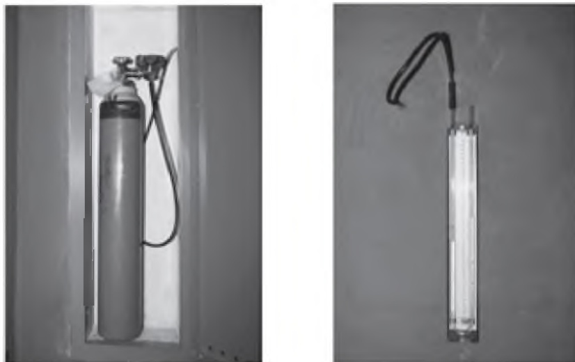
Rys. 21.13 Butla z gazem wzorcowym i U-rurka do pomiaru różnicy ciśnień przed i za tamą
