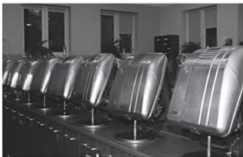
Rys. 21.4 Sala aparatowa – aparaty W-70
