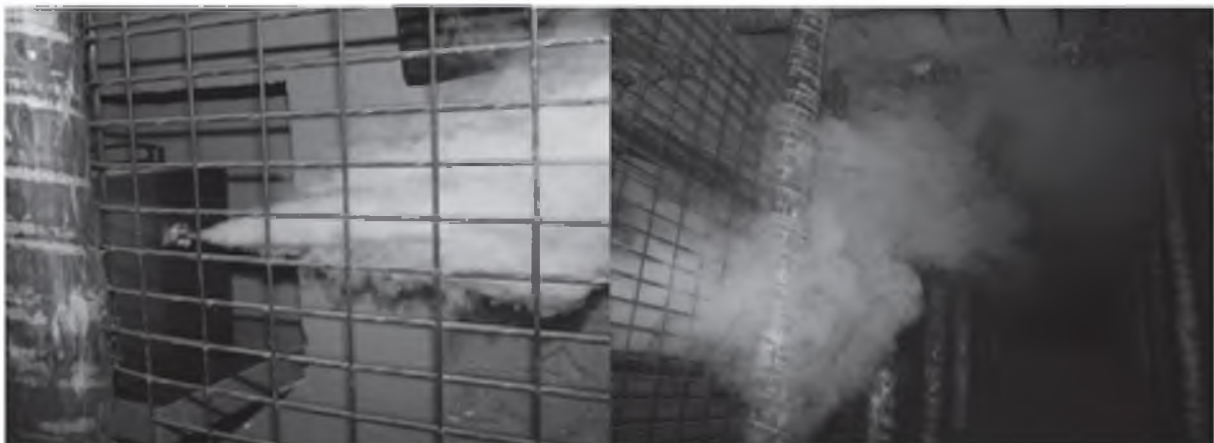
Rys. 21.14 Urządzenie do zadymiania komory
