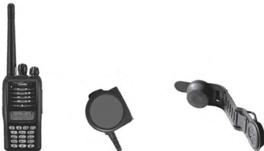
Rys. 21.1 Aparat BWRI z przyciskiem PTT i mikrofonem kostnym
