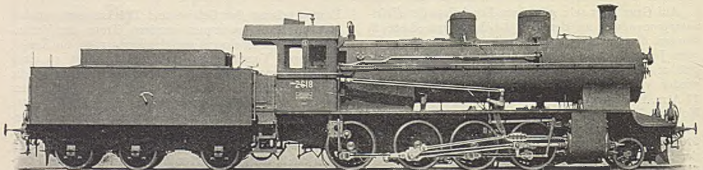
Abbildung 197. Gleichstrom-Zylinder, Steuerung System Stumpf.
