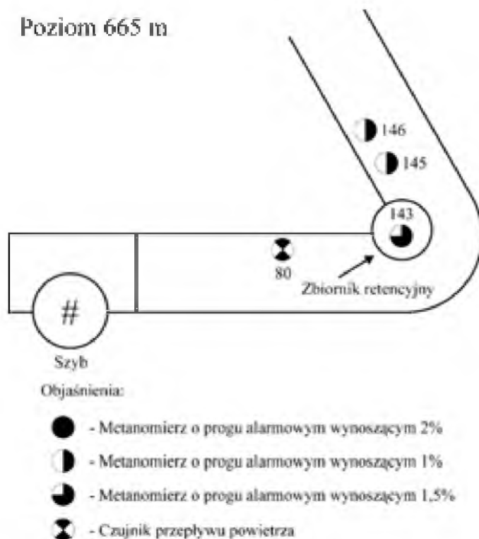
Rys. 5.2 Rozmieszczenie czujników w otoczeniu zbiornika retencyjnego, Który jest kontrolowany przez czujnik metanu nr 143
