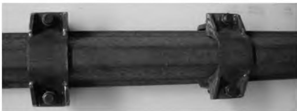
Rys. 2.1 Widok złącza ciernego z dwoma strzemionami typu SDO29w
