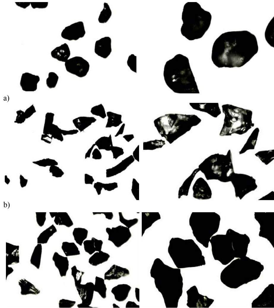
c) Rys. 1. Cząstki a) wzorcowego piasku kwarcowego( \text{SiO}_2 ), b) węgliku krzemu ( \text{SiC} ), c) tlenku aluminium ( \text{Al}_2\text{O}_3 ). (powiększenie 5x i 10x)
