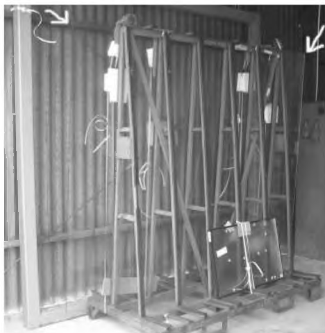
Rys. 7.2 Stojak typu piramida, przeznaczony do przewożenia dużych szyb.
