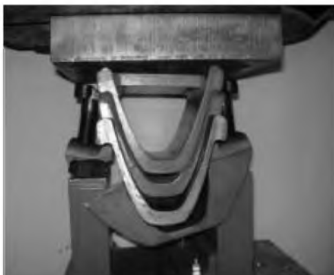
Rys. 6.4 Jarzmo dolne strzemienia SKL29 po próbie zginania
