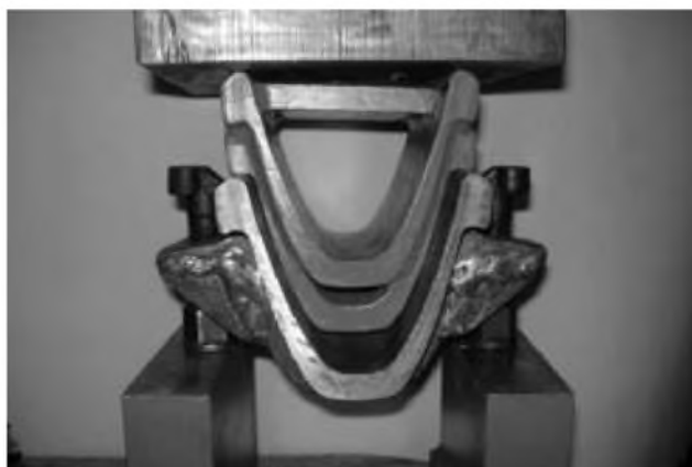
Rys. 6.5 Wzmocniona konstrukcja jarzma dolnego strzemienia SDO29 w trakcie badania
