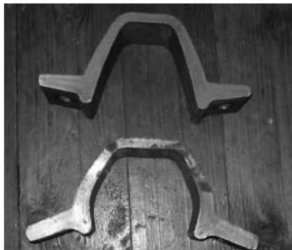
Rys. 6.15 Widoki jarzm dolnych strzemia SDO29 przed i po badaniu
