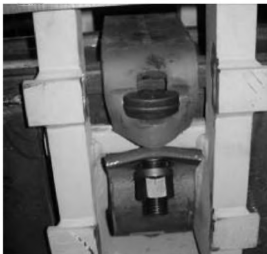
Rys. 6.9 Widok strzemia SDO29 po badaniu na rozciąganie
