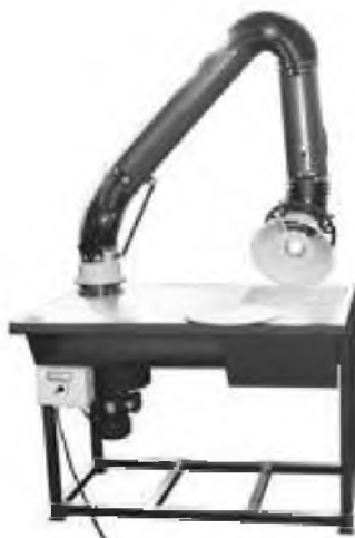
Rys. 10.3 Urządzenie odciągowe ze stołem spawalniczym (stanowisko spawalnicze typu S-1000) bez filtracji, wyposażone w wentylator 0,75kW, ramię Oskar (zasięg max 2m) [17]
