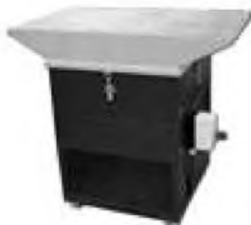
Rys. 10.4 Urządzenie filtrowentylacyjne do prac szlifierskich - stanowisko wyposażone w kompaktowy wkład filtracyjny i filtr wstępny metalowy [17]
