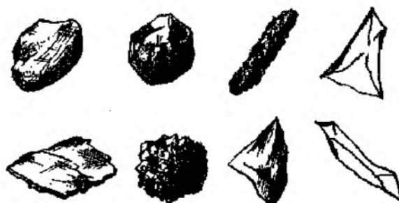
Rys. 10.1 Przykłady kształtu cząstek pyłu [2]
